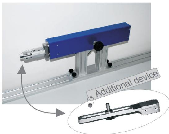
Grâce à son système de clampage, il est possible de torsader des fils avec des cosse aux extrémités sans abimer les contacts.
