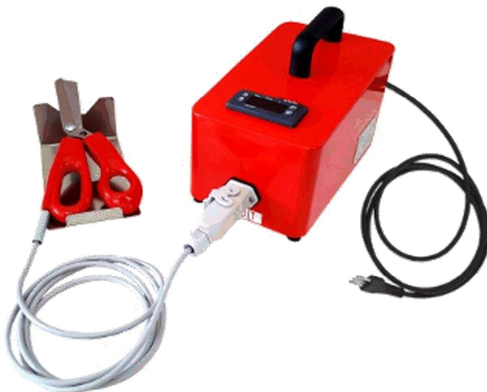
Les **Hot Scissors 1** sont des ciseaux pour la coupe à chaud et la cicatrisation (seul polyéthylène et polypropylène) des matériaux synthétiques. Les HS1 sont équipées d'un transformateur alimenté en 220 V /24 V, afin de garantir un maximum de sécurité pour l'utilisateur. Les ciseaux sont aussi équipés d'un support en acier inoxydable pratique et fonctionnel.
