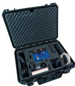
Le **PAL4000** est l'outil indispensable pour le contrôle périodique des presses, il permet la vérification des presses selon les spécifications du service qualité et de simplifier le réglage des presses pour le service maintenance. Fournit dans une mallette de transport rigide, le **PAL4000** peut être déplacé sans risque d'un site à un autre.
